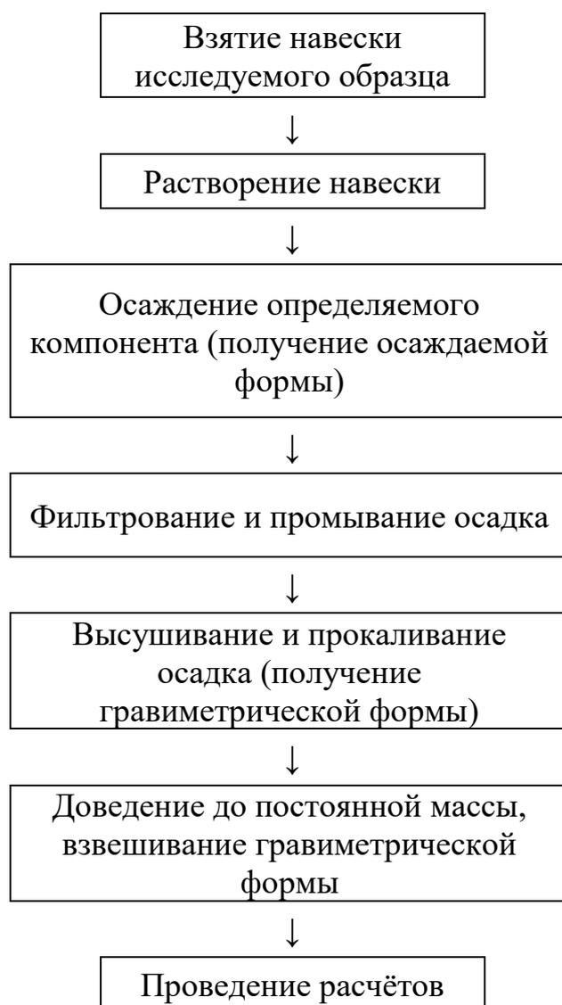
Рис. 1. Схема проведения гравиметрического анализа
