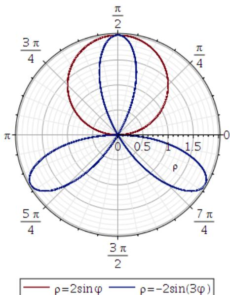
В общем случае если задана непрерывная неотрицательная на отрезке  $\phi = [\alpha; \beta]$  функция в полярной системе координат, то фигура, ограниченная отрезками лучей  $\phi = \alpha, \phi = \beta$  и графиком  $\rho = \rho(\phi)$ , названная **криволинейным сектором**, имеет площадь, равная
