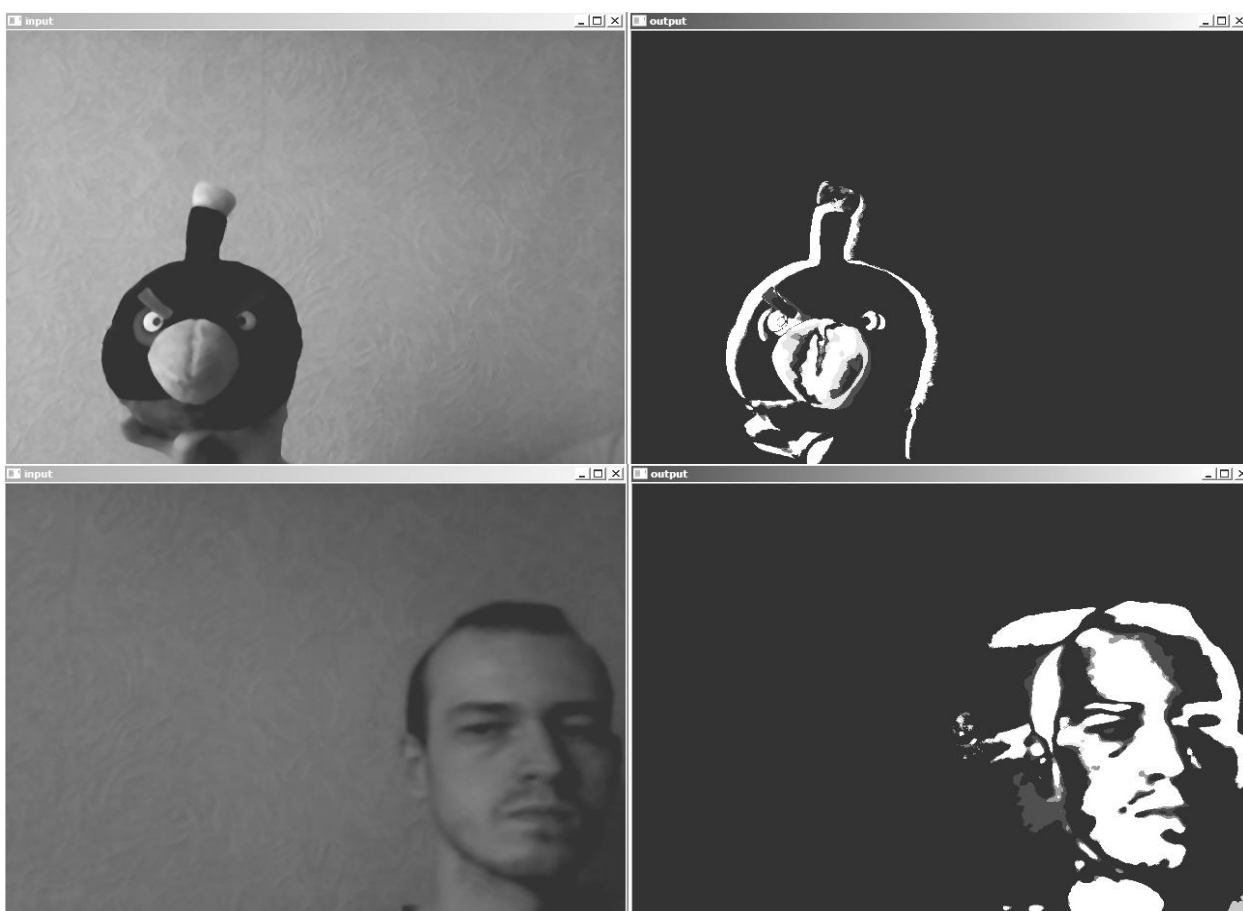
Рис. 3. Метод усреднения \alpha = 0.1 с фильтром Гаусса
