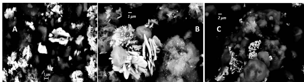
Figure 1: A) Cu/ZnAl 2 O 4 , B) Cu/MgAl 2 O 4 , C) Cu/Al 2 O 3 systems
