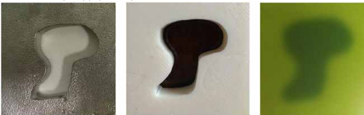
Рисунок 7. Внешний вид металлического (слева) и пластикового (по центру) коллиматоров и сформированное терапевтическое поле (справа)
