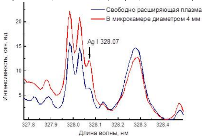
Рисунок 4. Спектр свободно расширяющейся плазмы и в микрокамере при испарении руды.
