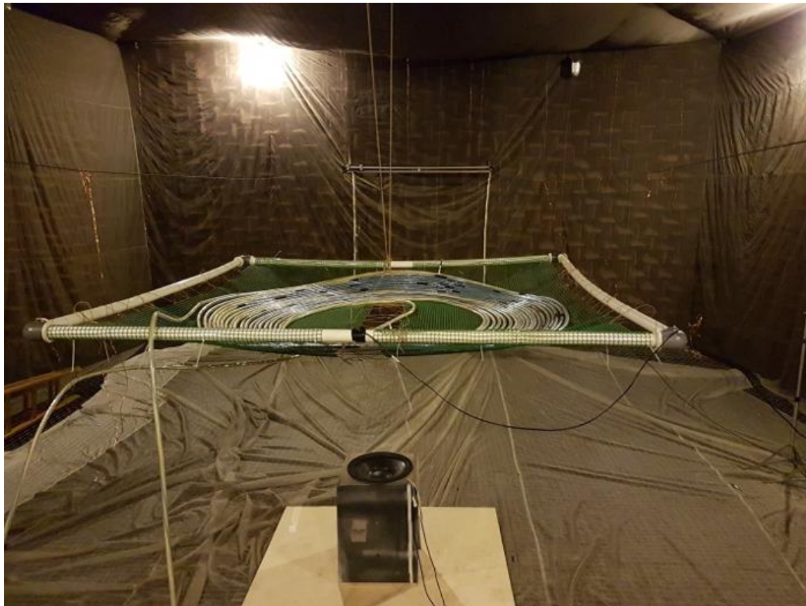
Рис.2 Испытание макета ИВОК в безшумной камере.
