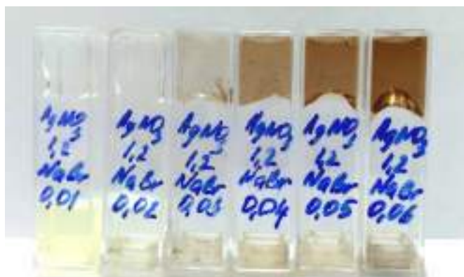
Рисунок. Фотография образцов гелей с различным содержанием бромида натрия: C_{NaBr} = 0,25-1,5 мМ; C_{AgNO_3} = 6,0 мМ; C_{L-cys} = 3,0 мМ, время выдержки образцов - 30 дней
