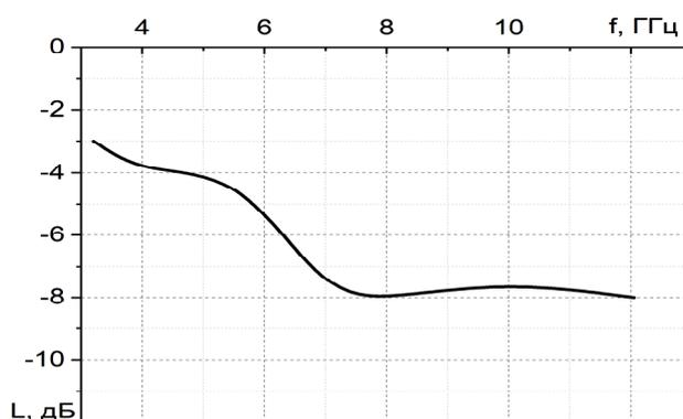
**Рис. 2.** Спектр поглощения энергии электромагнитного поля композита 80%Fe20%ПЭ
