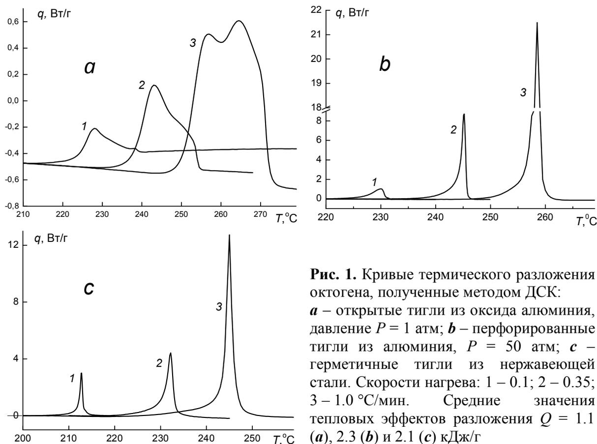
**Рис. 1.** Кривые термического разложения октогена, полученные методом ДСК: **a** – открытые тигли из оксида алюминия, давление  $P = 1$  атм; **b** – перфорированные тигли из алюминия,  $P = 50$  атм; **c** – герметичные тигли из нержавеющей стали. Скорости нагрева: 1 – 0.1; 2 – 0.35; 3 – 1.0 °C/мин. Средние значения тепловых эффектов разложения  $Q = 1.1$  (a), 2.3 (b) и 2.1 (c) кДж/г
