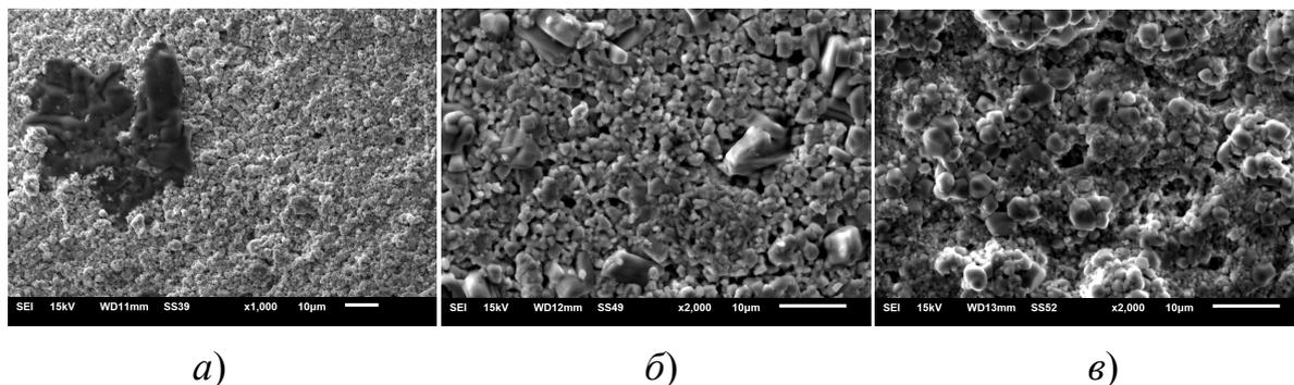
**Рис. 1.** РЭМ изображения структуры керамики KNN, модифицированной Ti
