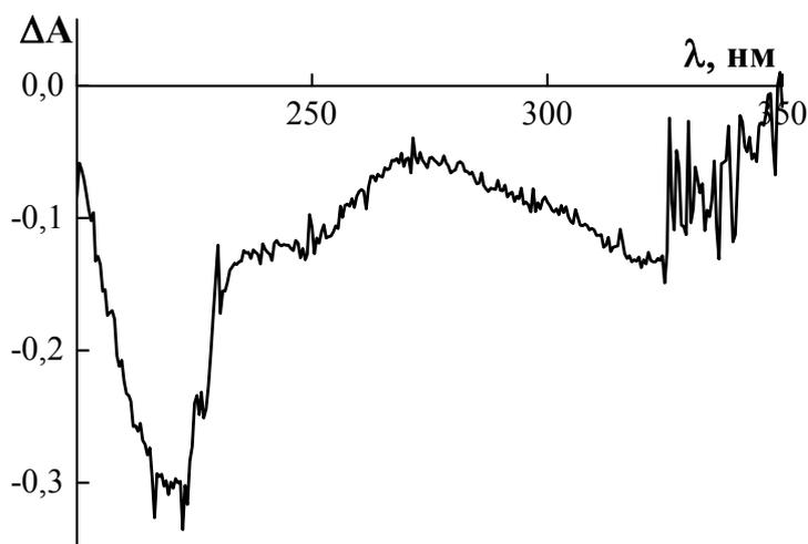
**Рис. 2.** Дифференцирование спектра раствора смеси В<sub>6</sub> и ГН относительно поглощения растворов В<sub>6</sub> и ГН.
