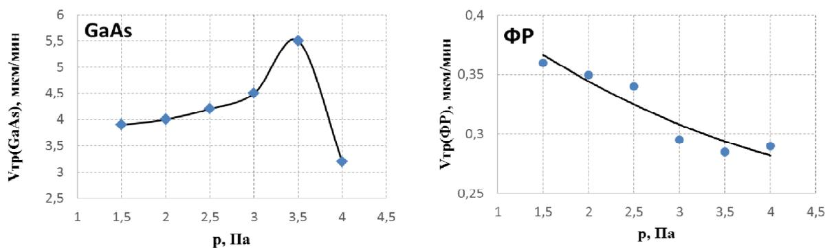
**Рис. 2.** Зависимости скорости травления GaAs и ФР от давления ( $P_{\text{ICP}} = 850 \text{ Вт}$ ,  $U_{\text{RF}} = 50 \text{ Вт}$ )
