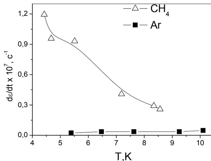
**Рис. 1.** Температурная зависимость скорости стационарной ползучести твердых метана и классического (не квантового) аргона в интервале температур 9-4 К [2]
