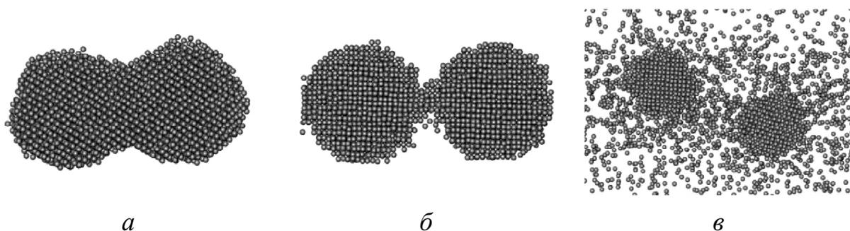
**Рис. 2.** Центральные сечения дочерних наночастиц, образовавшихся при спекании двух наночастиц Ni, содержащих 3000 атомов, при  $T=1000$  К спустя 1 нс в матрице Pb (*a*), Cu (*б*) и спустя 0,5 нс в матрице Al (*в*) (показаны только атомы Ni)
