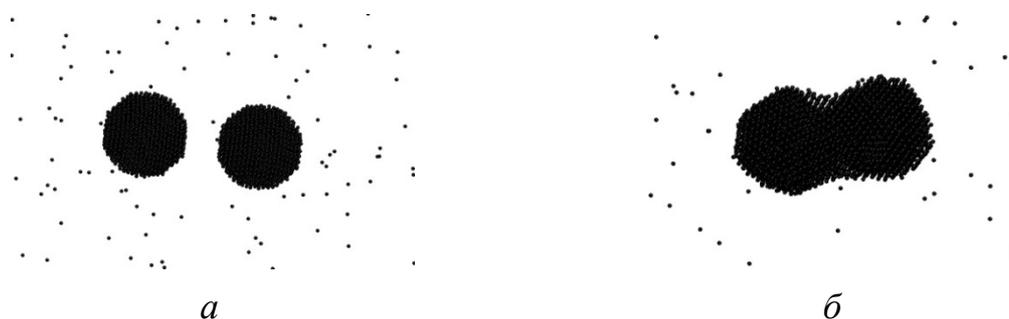
**Рис. 4.** Мгновенные конфигурации системы, состоящей из двух наночастиц этана, содержащих по 3043 атомов каждая и 1410 атомов пересыщенного пара этана. *А* – начальная конфигурация, *б* – после 10 нс релаксации при  $T = 70$  К
