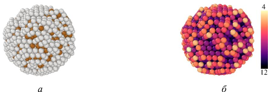
**Рис. 4.** Вид (а, серые атомы  $Pt$ ) и координационные числа атомов НЧ (б) после избирательной коррозии
