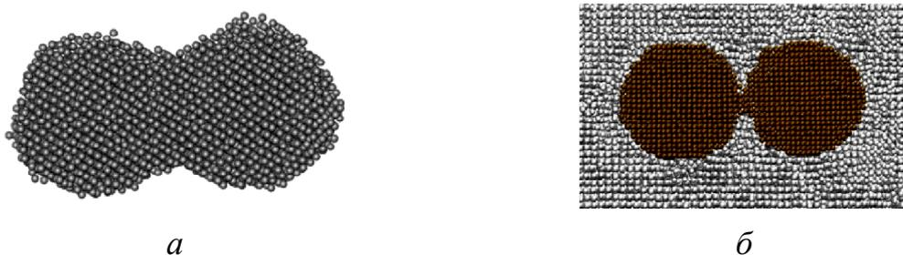
**Рис. 1.** Центральные сечения дочерних наночастиц, образовавшихся при спекании двух наночастиц Ni, содержащих 3000 атомов, в течение 1 нс при  $T=600$  в вакууме (а) и в матрице Cu (б)
