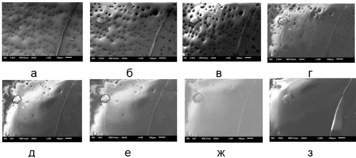
**Рис. 1.** Изображения доменной структуры, полученные для образца ТГС:  $\text{Co}^{2+}:\text{Cr}^{3+}$  при различных ускоряющих напряжениях: а) 1,5 кВ; б) 2,0 кВ; в) 2,5 кВ; г) 3,0 кВ; д) 4,0 кВ; е) 5,0 кВ; ж) 6,0 кВ; з) 10,0 кВ
