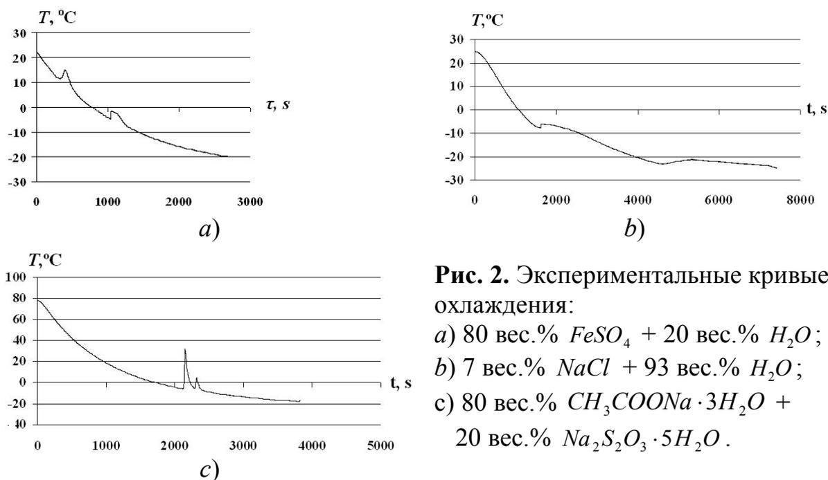
**Рис. 2.** Экспериментальные кривые охлаждения:
