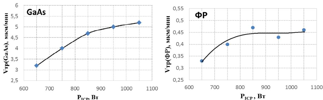
**Рис. 1.** Зависимости скорости травления GaAs и ФР от мощности источника ИСП ( $p = 2$  Па,  $U_{RF} = 50$  Вт)
