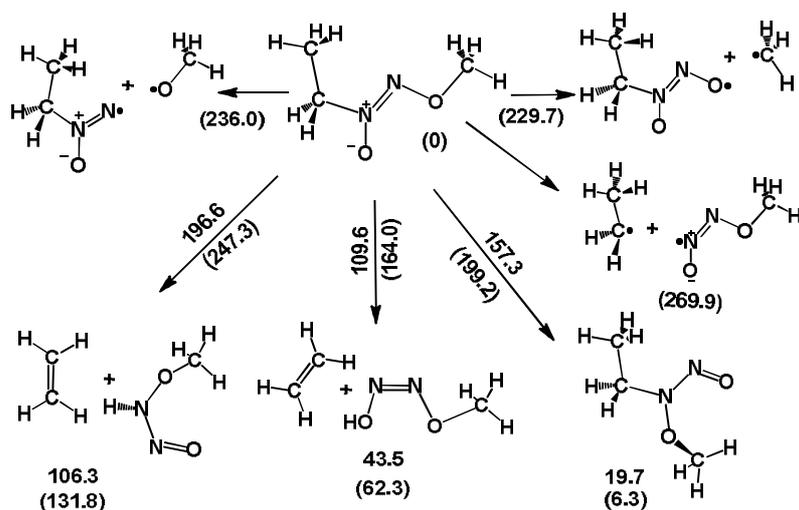
**Рис. 2.** Механизм термораспада N-этил-N'-метоксидиазен-N-оксида (II) по данным метода функционала плотности PBE/L11 (в скобках wB97XD/6-31G(2df,p)). Относительные энтальпии образования переходных состояний, реагентов и продуктов реакций в Ккал/моль. За ноль принята энтальпия образования N-метил-N'-метоксидиазен-N-оксида
