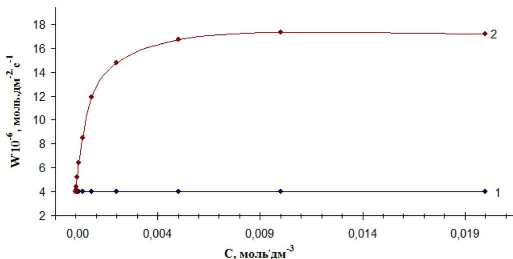
**Рис. 1.** Зависимость удельной скорости растворения хизлевудита в азотной кислоте (1) от концентрации  $\text{Fe}^{3+}$  (2) при 298 К и  $\omega = 10 \text{ с}^{-1}$
