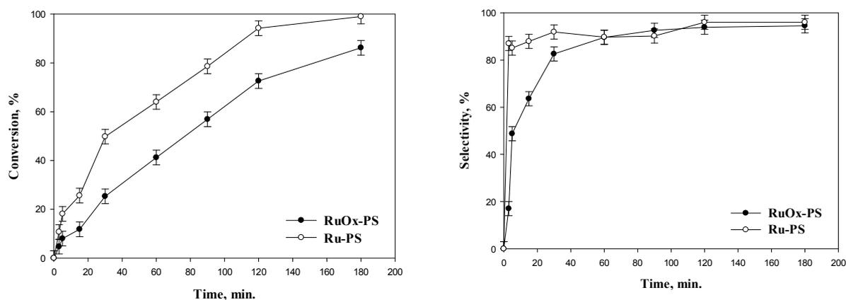
**Рис. 2.** Графики зависимости конверсии фурфурола и селективности фурфуролового спирта от времени
