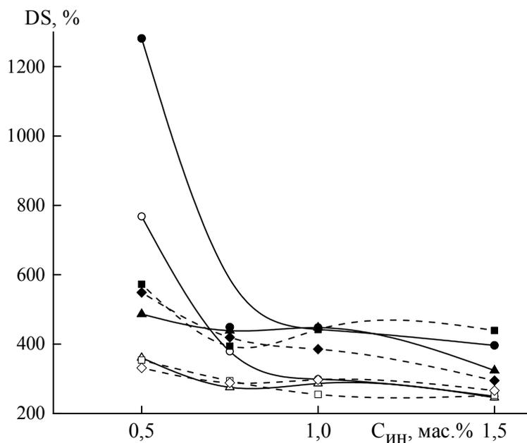
**Рис. 1.** Зависимость степени набухания от концентрации инициатора для пленок, полученных с предварительной механообработкой (●, ○, ■, □) и без нее (▲, △, ◆, ◇) и термообработкой при 100 °С в течение 1 ч (●, ○, ▲, △) или 2 ч (■, □, ◆, ◇); соотношение ПВП:ПВС 1:4 (●, ▲, ■, ◆) и 2:3 (○, △, □, ◇)
