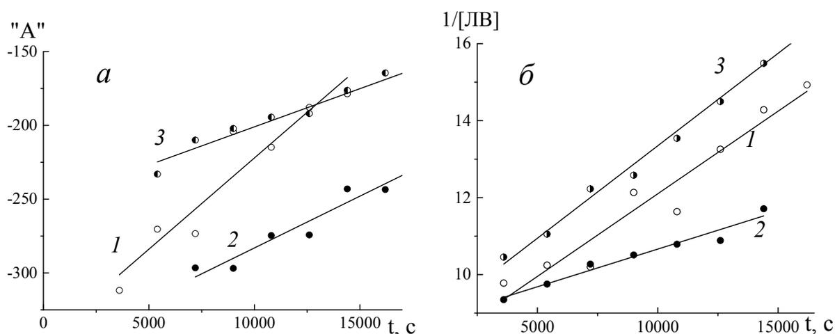
**Рис. 2.** Зависимости “А” (а) или 1/[ЛВ] (б) от времени для реакции ЯА с БК (1), СА (2) и НК (3) при 70 °С. [ЯА]<sub>0</sub> = [ЛВ]<sub>0</sub> = 0,1 моль/л
