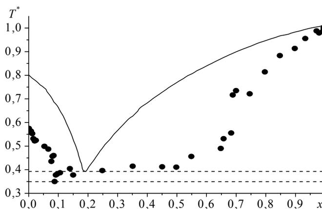
**Рис. 2.** Сравнение фазовой диаграммы, полученной по результатам наших МД экспериментов для наночастиц Au-Si, содержащих 2000 атомов (точки), с экспериментальной фазовой диаграммой объемного сплава [6], показанной сплошной линией.  $T^*$  – приведённая температура. Точки отвечают нашим МД результатам для линии ликвидуса, штриховые линии – соответствующим линиям солидуса
