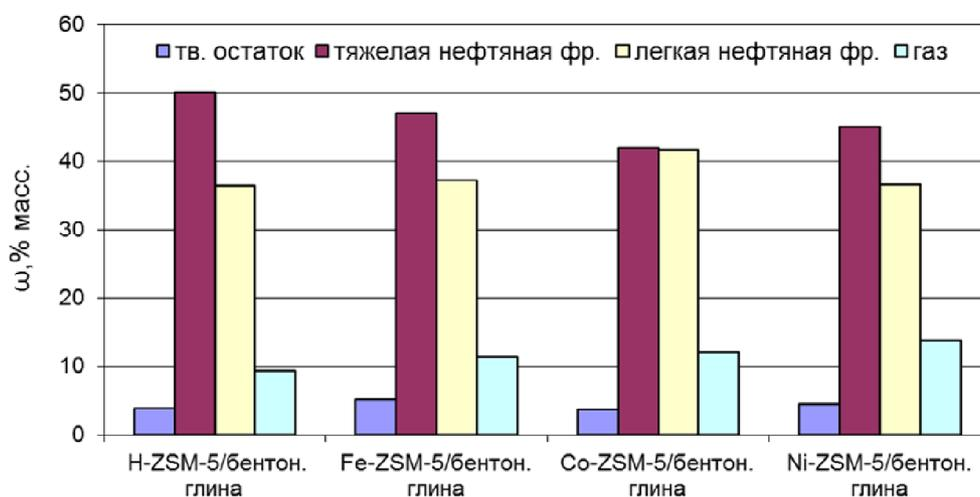
**Рис.** Зависимость массовой доли продуктов пиролиза от вида активного металла в катализаторе
