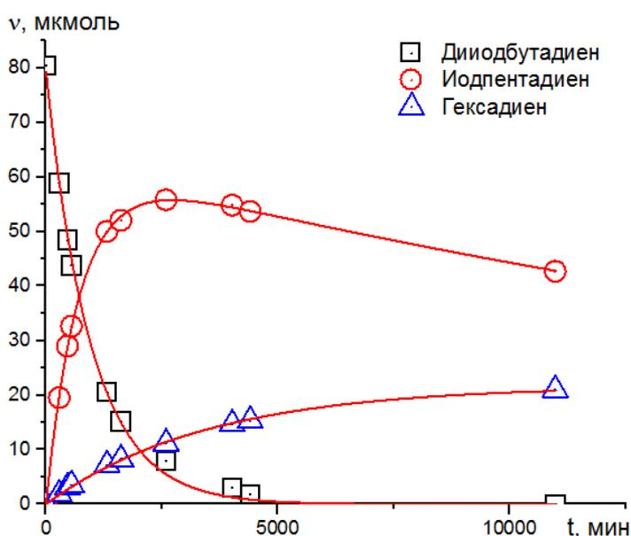
**Рис. 2.** Кинетика реакции в системе  $\text{Pt}^{\text{II}} - \text{NaI} - \text{C}_4\text{H}_4\text{I}_2 - \text{CH}_3\text{I} - \text{ацетон-}d_6$  при  $40^\circ\text{C}$
