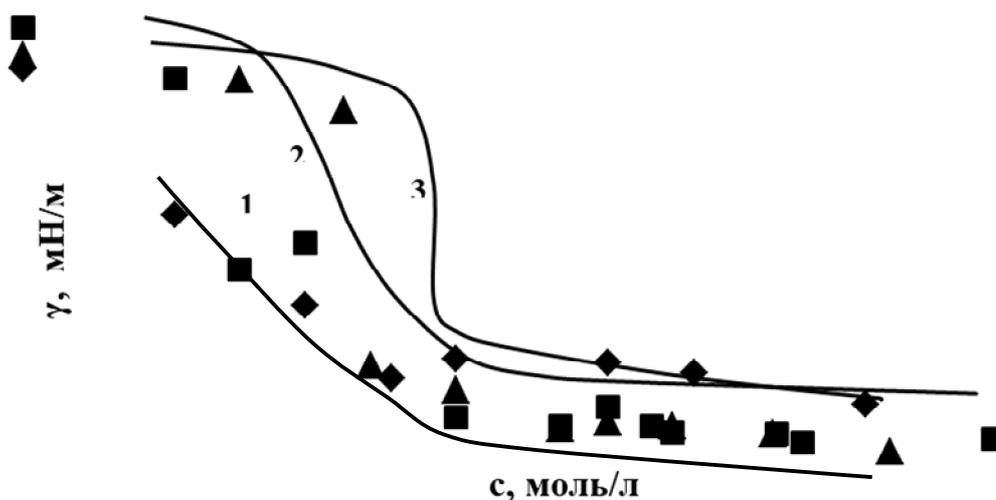
**Рис. 2.** Изменение равновесного поверхностного натяжения растворов дикаationных имидазолиевых ПАВ с различной длиной мостикового фрагмента от концентрации:  $m$ , 1 – 4, 2 – 3, 3 – 2
