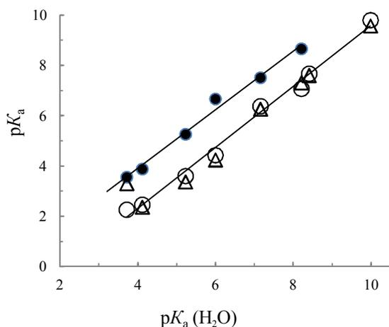
**Рис. 1.** Зависимость величин  $pK_a$  фенолов в 30% EtOH (1M KCl) (●), в ЦТАБ (○) и GS (Δ) от  $pK_a$  (H<sub>2</sub>O); 25 °C
