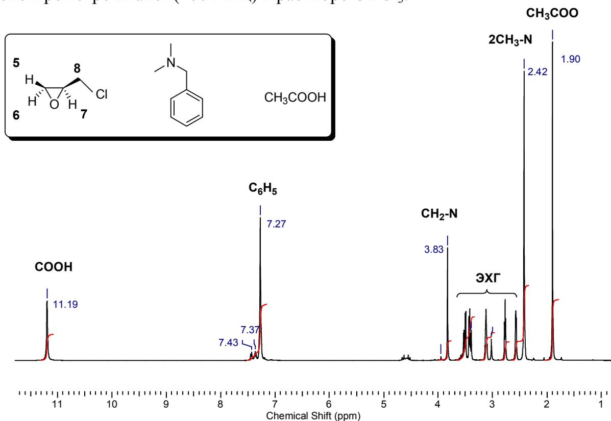
**Рис. 1.** ЯМР <sup>1</sup>H спектр реакционной системы «BnNMe<sub>2</sub> – эпихлоргидрин – AcOH» в начальный момент времени
