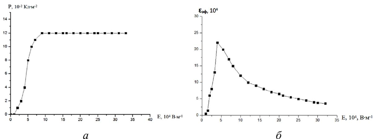
**Рис. 1.** Полевые зависимости переключаемой поляризации (*a*) и эффективной диэлектрической проницаемости (*б*), полученные для кристалла  $\text{BaTiO}_3 : \text{Nb}^{5+}$  ( $C=0,1$  мол. %).
