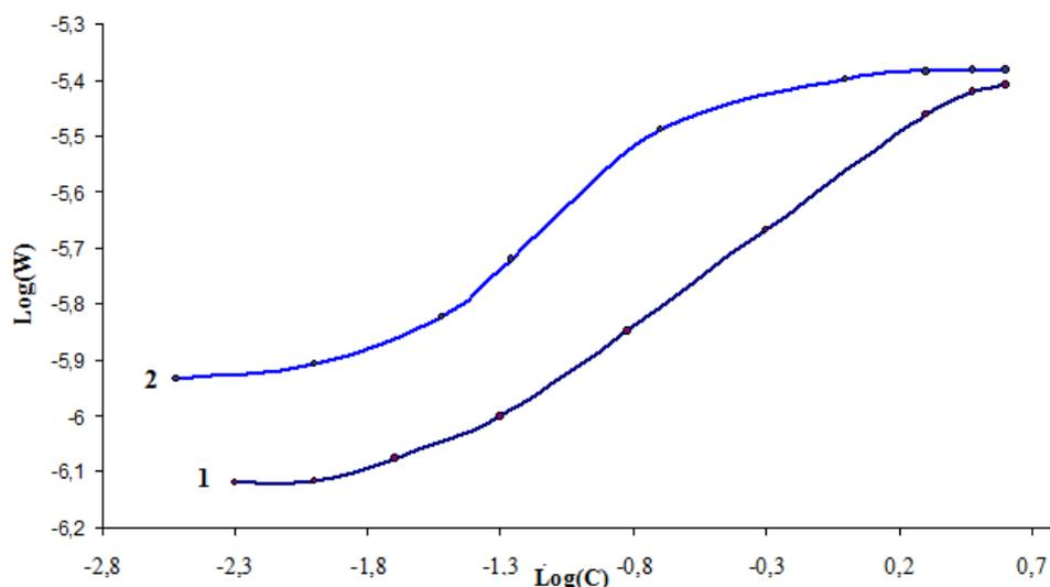
**Рис. 2.** Логарифмическая зависимость удельной скорости растворения хизлевудита от концентрации серной кислоты (кривая 1) и азотной кислоты (кривая 2) при  $T = 298$  К
