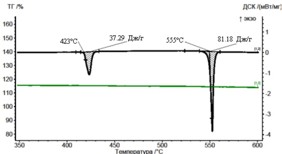
**Рис.** Термограмма ДСК невариантного состава системы  $\text{NaCl-NaBr-Na}_2\text{CrO}_4$
