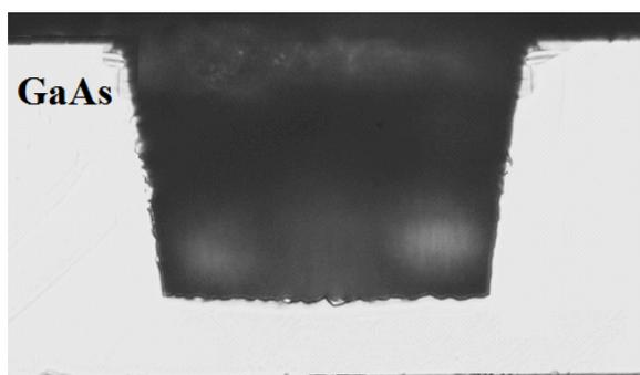
**Рис. 3.** Морфология боковых стенок и дна профилируемой пластины ( $h=100 \text{ мкм}$ )
