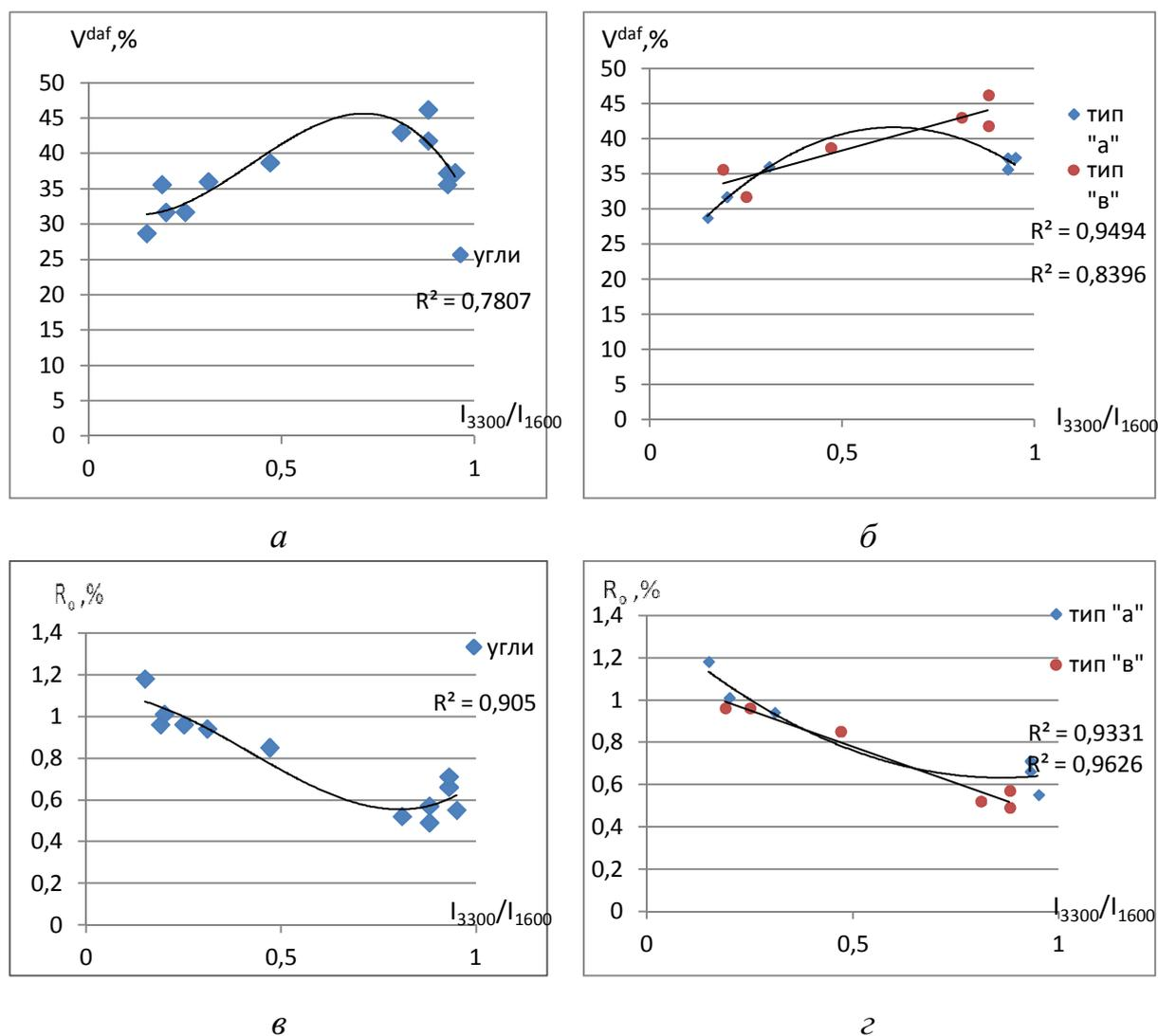
**Рис. 1.** Корреляционные зависимости между структурным параметром  $I_{3300}/I_{1600}$  и технологическими параметрами: а, б) выходом летучих веществ –  $V^{daf}$ ; в, г) показателем отражения витринита –  $R_v$ ; б, г) отдельно для углей типов «а» и «в»; а, в) – при совместной обработке
