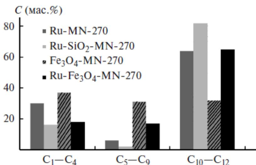
**Рис. 1.** Распределение продуктов синтеза Фишера-Тропша для синтезированных образцов
