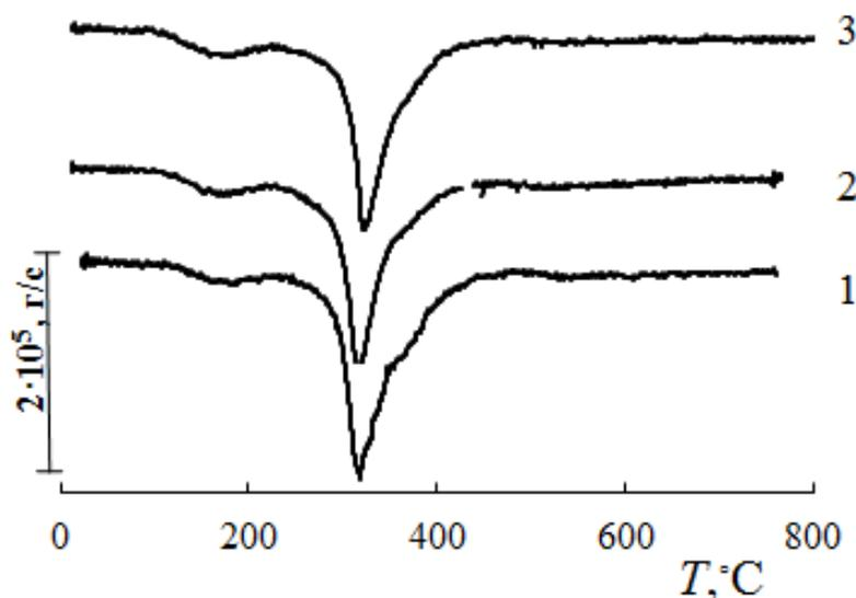
**Рис. 1.** Кривые DTG, соответствующие немодифицированному полимеру (1), композиту с 0,5 (2) и 3 масс. % SiO<sub>2</sub> (3)
