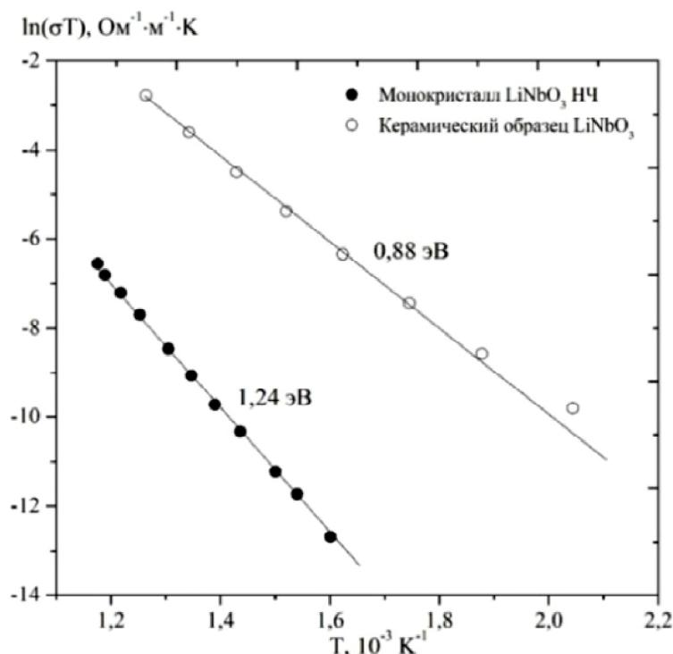
**Рис. 2** – Температурные зависимости статической удельной проводимости керамического НЛ и конгруэнтного монокристалла НЛ
