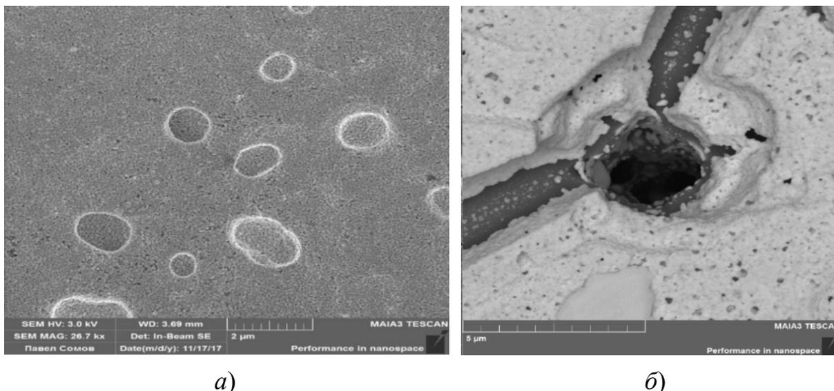
**Рис. 1.** Данные растровой электронной микроскопии por-Si/Ag до (a) и после (б) процесса функционализации соответственно
