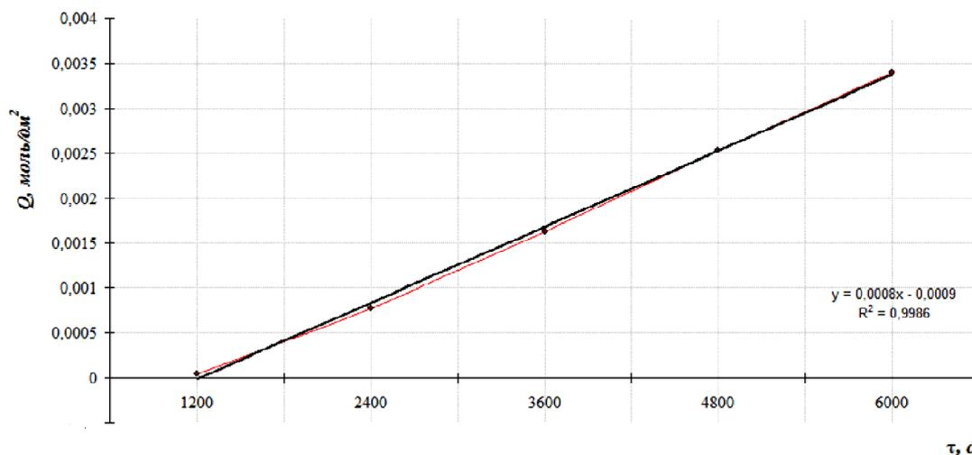
**Рис. 1.** Зависимость количества перешедшего в раствор  $\text{Ni}^{2+}$  от времени процесса растворения хизлевудита при  $C(\text{H}_2\text{SO}_4) = 0.01$  моль·эquiv/дм<sup>3</sup>,  $T = 298$  К и  $\omega = 10$  с<sup>-1</sup>
