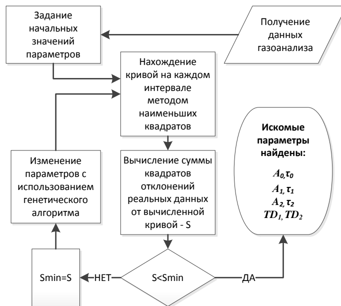
Рис. 2. Блок-схема алгоритма оценки параметров модельной кривой по данным газоанализа
